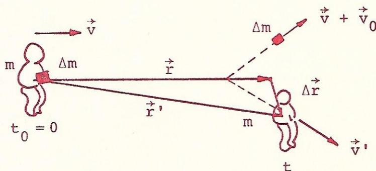
$$(m + \Delta m)\vec{v} = \Delta m(\vec{v} + \vec{v}_0) + m\vec{v}' \Rightarrow \vec{v}' = \vec{v} - \frac{\Delta m}{m}\vec{v}_0$$
