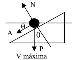
**Solução:-** Para que o carro não derrape, a resultante de  $N$  (normal),  $P$  (peso) e  $A$  (atrito) deve ser igual à força centrípeta ( $mv^2/R$ ).
