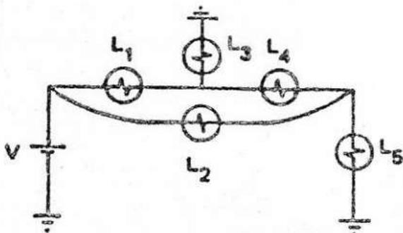
No circuito mostrado na figura existem cinco lâmpadas iguais. Quatro estão acesas e uma apagada. Determine a lâmpada que está apagada e justifique sua resposta.
