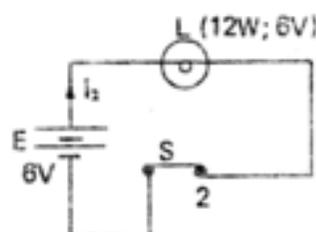
Com a chave na posição 3 e lembrando que o circuito é de corrente contínua, ocorre apenas um aumento da resistência externa do circuito, em relação à situação anterior. Nestas condições  $i_2 > i_3$ , e portanto,  $I_2 > I_3$ .
