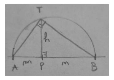
Em uma reta suporte, marcamos PA para a esquerda e PB para a direita, traçamos a semicircunferência com diâmetro AB e T será a interseção da semicircunferência com a perpendicular a AB por P.
